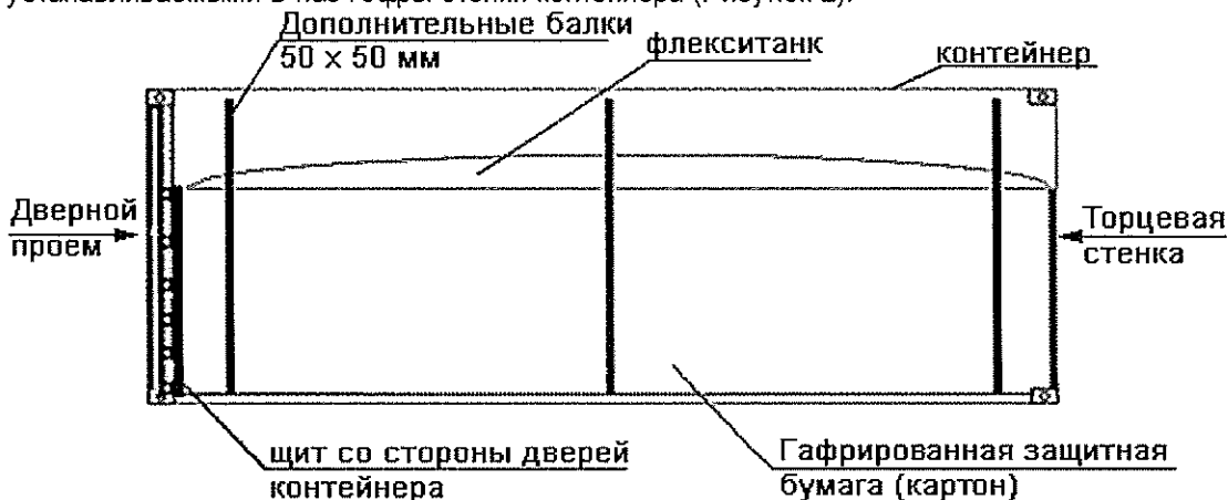
Рисунок 2 (Размещение вертикальных металлических балок 50 x 50 x 3 мм)
